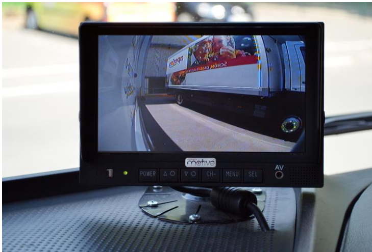
(Bild: Betätigt der Fahrer den rechten Blinker, schaltet sich der Monitor ein und die Kamera zeigt ein Live-Bild des Umfelds. © apetito, Rheine)
