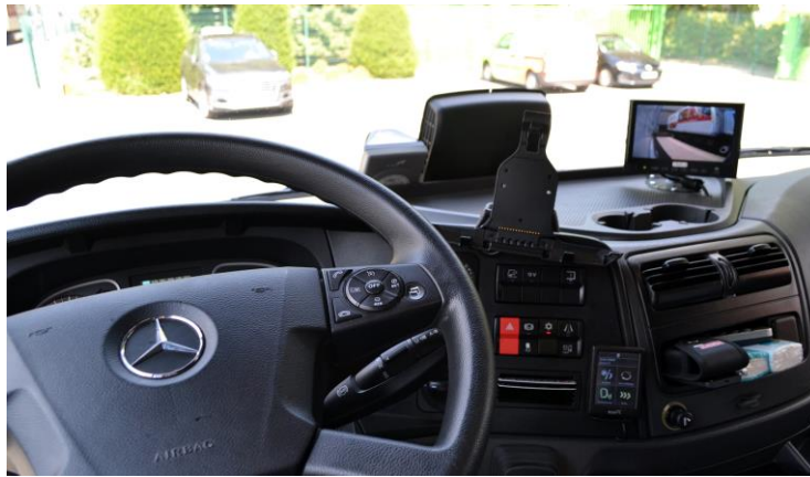
(Bild: Blick aus der Fahrerperspektive auf den Monitor. Bislang bot dieser dem Fahrer Unterstützung beim rückwärts Rangieren. © apetito, Rheine)
