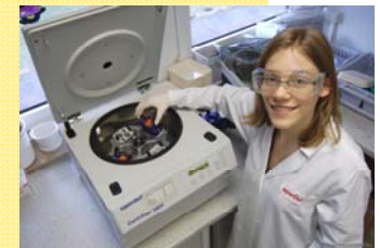
Die Paprika wird zentrifugiert, so dass sich die festen Stoffe am Boden sammeln. Die Flüssigen Stoffe sind oben. 5
